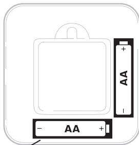
Coloque baterías AA alcalinas nuevas y reinstale el controlador. Asegúrese de que la polaridad de las baterías coincida con las marcas +/- en el interior del compartimento de la batería.
