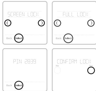
**Remarque :** Un écran partiellement ou totalement verrouillé est indiqué par un symbole de verrou dans le bas de l'écran du contrôleur. Le verrouillage complet, le verrouillage partiel et les paramètres d'ISU 161 à 167 peuvent déclencher le symbole de verrou, mais seuls les verrouillages complet et partiel peuvent être déverrouillés avec le NIP.
