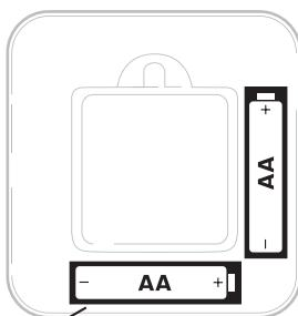
Insérez des piles alcalines AA neuves, puis réinstallez le contrôleur. Faites correspondre la polarité des piles aux marques +/- dans le compartiment de piles.
