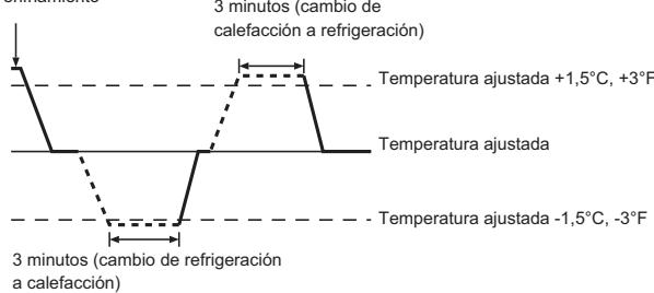
■ Como la temperatura ambiente se ajusta automáticamente para mantener una temperatura efectiva fija, el modo de refrigeración se activa un par de grados por encima de la temperatura ajustada (y el modo de calefacción, un par de grados por debajo) una vez alcanzada dicha temperatura (modo automático de ahorro de energía).
