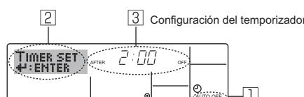
1. Asegúrese de que usted se encuentre en una pantalla de control estándar y que el indicador del temporizador de apagado automático Auto Off se muestre en la pantalla (en ①).
