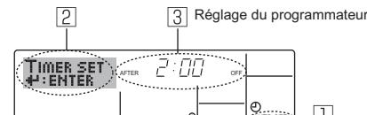
1. Assurez-vous que vous êtes sur un écran de contrôle standard, et que le témoin du programmeur Arrêt Auto s'affiche (en ①). Lorsqu'une fonction autre que le temporisateur à extinction automatique est affichée, réglez la télécommande sur AUTO OFF TIMER en utilisant le paramètre de fonction temporisateur de la sélection des fonctions (voir 8.4[4]-3 (3)).
