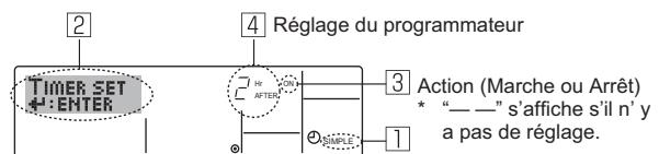
1. Assurez-vous que vous êtes sur un écran de contrôle standard, et que le témoin du programmeur simple s'affiche (en ①). Lorsque qu'une fonction autre que le temporisateur simple est affichée, réglez la télécommande sur SIMPLE TIMER en utilisant le paramètre de fonction temporisateur de la sélection des fonctions (voir 8.[4]-3 (3)).
