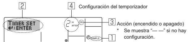
1. Asegúrese de que se encuentra en una pantalla de control estándar y de que el indicador de temporizador simple se muestra en la pantalla (en ①). Cuando aparezca una indicación distinta de la del temporizador simple, cámbielo a SIMPLE TIMER (TEMPORIZADOR SIMPLE) utilizando la selección n de funciones del temporizador del mando a distancia (véase 8.[4]-3(3)).
