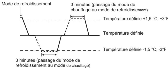
■ La température de la pièce étant ajustée automatiquement de façon à rester stable, l'opération de refroidissement se met en marche à quelques degrés au-dessus, et l'opération de chauffage à quelques degrés au-dessous, de la température définie lorsque cette dernière est atteinte (fonction automatique d'économie d'énergie).
