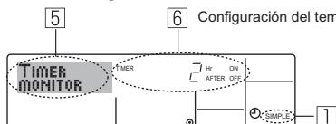
1. Asegúrese de que el indicador del temporizador simple está visible en la pantalla (en ①).
