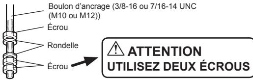
[Lors de l'utilisation d'un caoutchouc anti-vibrations (préparé par le client)] Lors de l'utilisation d'un caoutchouc anti-vibrations (préparé par le client), il y a un risque de diminution de la force, c'est pourquoi nous recommandons le type de construction suivant.
