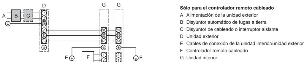
\* Coloque una de las etiquetas A incluidas con los manuales cerca de cada esquema de cableado de las unidades interiores y exterior.
