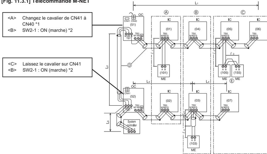
\*1 : Quand l'alimentation n'est pas connectée à la ligne de transmission pour la commande centralisée, débranchez le connecteur mâle de l'alimentation (CN41) sur UN appareil extérieur du système et connectez-le à CN40.
