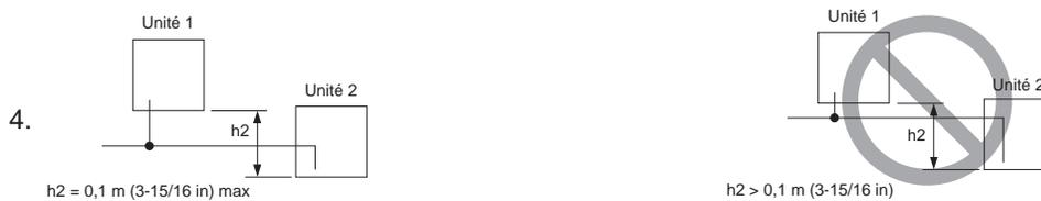
L'exemple NG illustre une accumulation d'huile dans l'unité 2, que l'unité 1 est en cours d'utilisation et que l'unité 2 est arrêtée. La différence entre l'unité et l'unité en hauteur (h2) doit être de 0,1 m (3-15/16 in) maximum.
