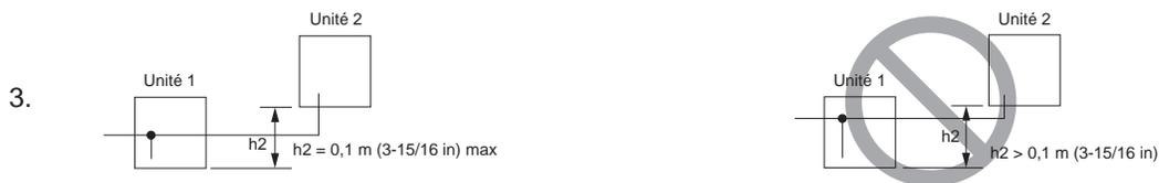
L'exemple NG illustre une accumulation d'huile dans l'unité 1, que l'unité 2 est en cours d'utilisation et que l'unité 1 est arrêtée. La différence entre l'unité et l'unité en hauteur (h2) doit être de 0,1 m (3-15/16 in) maximum.
