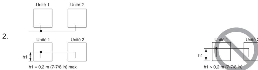
L'exemple NG illustre une accumulation d'huile dans l'unité 1, que l'unité 2 est en cours d'utilisation et que l'unité 1 est arrêtée. La hauteur (h1) du tube vertical doit être de 0,2 m (7-7/8 in) maximum.
