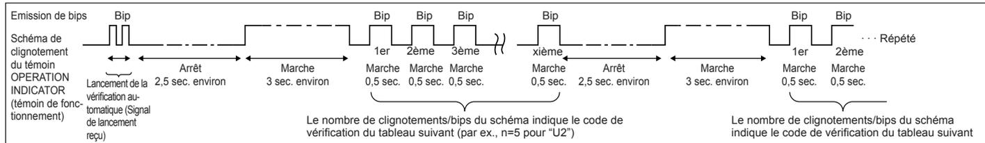
[Schéma de sortie A] Erreurs détectées par l'appareil intérieur
