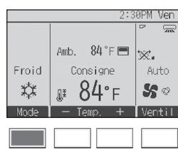
Chaque pression sur la touche [F1] fait défiler les modes de fonctionnement suivants. Sélectionnez le mode de fonctionnement souhaité.
