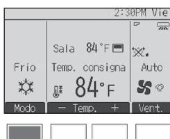
Cada vez que se presiona el botón [F1] se pasa por los siguientes modos de funcionamiento. Seleccione el modo de funcionamiento deseado.
