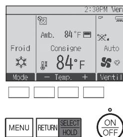
Appuyez sur la touche VERROUILLAGE pour activer/désactiver la fonction de verrouillage. Si la fonction de verrouillage est activée, les fonctions suivantes sont interdites et s'affiche.
