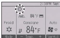
apparaît sur l'Écran principal de réglage en mode Complet lorsque l'Arrêt auto timer est activé. L'icône n'apparaît pas lorsque la fonction Verrouillage est activée.
