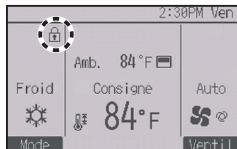
apparaît sur l'Écran principal de réglage en mode Complet lorsque la fonction verrouillage est activée.
