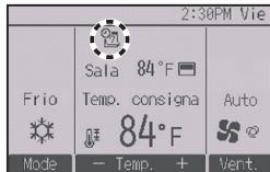
aparecerá en la pantalla principal en modo Completo cuando exista la configuración del programador semanal para el día actual. El ícono no aparecerá mientras el programador On/Off esté activado o el sistema esté bajo control centralizado (no es posible manipular el programador mediante el controlador remoto local), o mientras la función Bloqueo esté habilitada.
