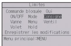
L'écran permettant de régler la fonction de verrouillage s'affiche.
