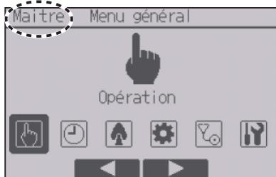
Les paramètres suivants ne peuvent pas être réglés depuis la télécommande secondaire. Faites ces réglages depuis la télécommande principale. "Main" est affiché dans le titre du Menu général sur la télécommande.
