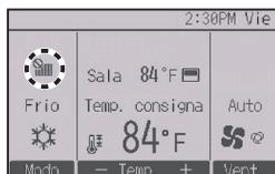
Cuando se muestra en la pantalla principal en el modo Completo, el sistema está controlado a nivel central y no se puede restaurar la señal del filtro.
