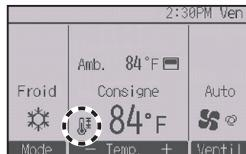
apparaît sur l'Écran d'état et l'Écran principal de réglage en mode Complet lorsque la plage de température est limitée.
