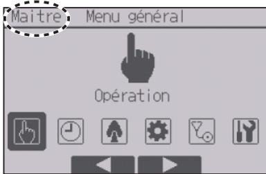
Les paramètres suivants ne peuvent pas être réglés depuis la télécommande superviseur. Faites ces réglages depuis la télécommande principale. "Main" est affiché dans le titre du Menu général sur la télécommande.
