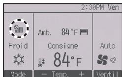
Lorsque le est affiché sur l'Écran principal de réglage en mode Complet, le système est contrôlé centralement et le témoin d'état du filtre ne peut pas être remis à zéro.
