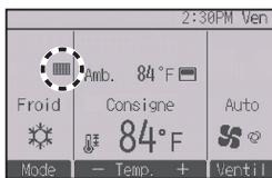
████████ apparaît sur l'Écran principal de réglage en mode Complet quand les filtres doivent être nettoyés.
