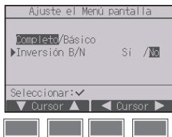
Seleccione “Inversión N/B” con el botón **F1** o **F2**, y seleccione el modo de visualización “Sí” o “No” con el botón **F3** o **F4**, y presione el botón **ACEPTAR/BLOQUEO**. (De forma predeterminada, se visualiza “No”.)
