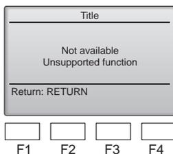
Le message à gauche s'affiche si l'utilisateur sélectionne une fonction non prise en charge par le modèle d'appareil intérieur considéré.
