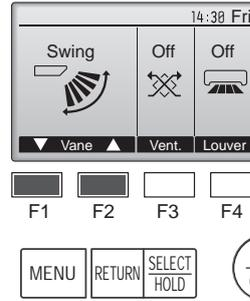
Pressez sur la touche [F1] ou [F2] pour choisir le réglage du déflecteur : "Auto", "Step 1" (Étape 1), "Step 2" (Étape 2), "Step 3" (Étape 3), "Step 4" (Étape 4), "Step 5" (Étape 5), et "Swing" (Balayage). Choisissez le réglage désiré.
