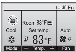
Cuando se muestra
