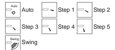
Seleccione "Swing" (Oscilación) para que los álabos se muevan hacia arriba y hacia abajo automáticamente. Cuando configure de "Step 1" (Posición 1) a "Step 5" (Posición 5), el álabo estará fijo en el ángulo seleccionado.
