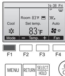
Cada vez que se pulsa el botón [F1] se alterna entre los siguientes modos de funcionamiento. Seleccione el modo de funcionamiento deseado.
