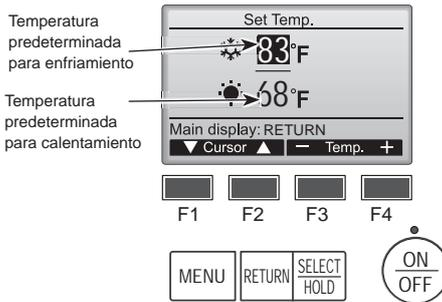
② Pulse el botón [F1] o [F2] para mover el cursor hasta el ajuste de temperatura deseado (refrigeración o calefacción). Pulse el botón [F3] para disminuir la temperatura seleccionada y [F4] para aumentarla.
