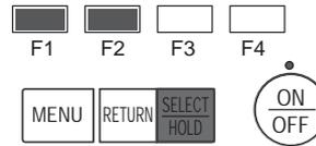
Seleccione "Vane-Louver-Vent. (Lossnay)" (Lama-Deflector-Vent. (Lossnay)) desde el menú Funcionamiento y pulse el botón [SELECT/HOLD].
