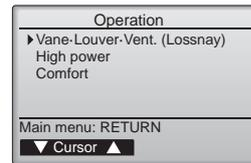
Dans le menu Operation (Fonctionnement), sélectionnez "Vane-Louver-Vent. (Lossnay)" (Vane-Volet-Vent. (Lossnay)) puis appuyez sur la touche [SELECT/HOLD].
