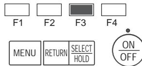
Presione el botón [F3] para pasar por las opciones de configuración de la ventilación en el siguiente orden: "Off" (Apagado), "Low" (Baja) y "High" (Alta).
