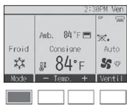
Chaque pression sur la touche [F1] fait défiler les modes de fonctionnement suivants. Sélectionnez le mode de fonctionnement souhaité.
