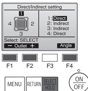
③ Si selecciona Directo/Indirecto, configure cada salida de aire. Seleccione la salida de aire con el botón [F1] o [F2], y cambie el ajuste con el botón [F4]. Después de cambiar la configuración de todas las salidas de aire, pulse el botón [SELECT/HOLD] para guardar la configuración. Para activar esta función, la dirección del flujo de aire debe ajustarse a "Auto".
