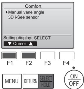
② Sélectionnez "Manual vane angle" (Angle de volet manuel) avec les touches [F1] ou [F2], et appuyez sur la touche [SELECT/HOLD].
