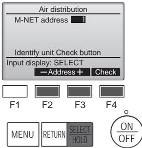
① Seleccione la "M-NET address" (dirección M-NET) para las unidades cuyos deflectores desea fijar con los botones [F2] o [F3] y pulse el botón [SELECT/HOLD]. Pulse el botón [F4] para confirmar la unidad. Solo el deflector de la unidad interior de destino apunta hacia abajo.
