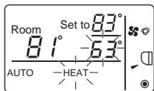
Si, mientras parpadea la temperatura predeterminada de calentamiento, se pulsa el botón **TEMP.▲**, ésta aumentará; y si se pulsa el botón **TEMP.▼**, se reducirá. Si se pulsa el botón **MODE**, se completará la configuración de temperatura predeterminada.
