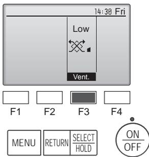
Presione el botón [F3] para pasar por las opciones de configuración de la ventilación en el siguiente orden: "Off" (Apagado), "Low" (Baja) y "High" (Alta).
