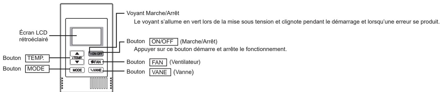
\* Pour régler les fonctions non disponibles sur ce contrôleur (PAC-YT53CRAU) comme la fonction Volet, utilisez le contrôleur à distance MA ou le contrôleur centralisé.
