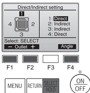
③ Quand Direct/Indirect est sélectionné, réglez chaque sortie d'air. Sélectionnez la sortie d'air à l'aide de la touche [F1] ou [F2], et changez le réglage à l'aide de la touche [F4].
