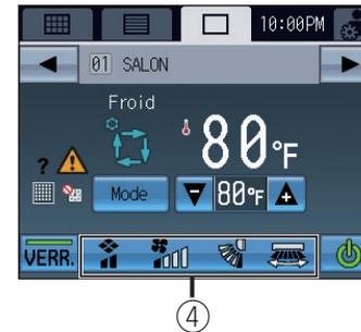
Touchez ④ pour afficher le réglage des unités de ventilation interdépendantes (LOSSNAY), de la vitesse du ventilateur, de la direction du flux d'air et des sorties d'air.
