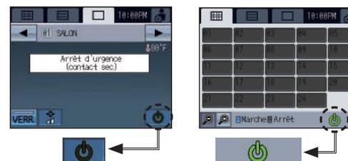
Si l'interface d'entrée externe reçoit un signal d'arrêt d'urgence, toutes les unités intérieures et LOSSNAY contrôlées par le TC-24A s'arrêtent. Le contrôleur TC-24A, les contrôleurs système bas niveau ou les télécommandes locales ne répondent pas tant que l'entrée du signal d'arrêt d'urgence n'est pas supprimée.
