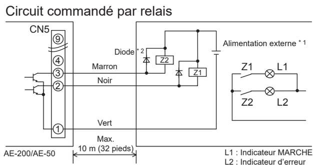
Utiliser des relais Z1 et Z2 conformes aux spécifications suivantes.
