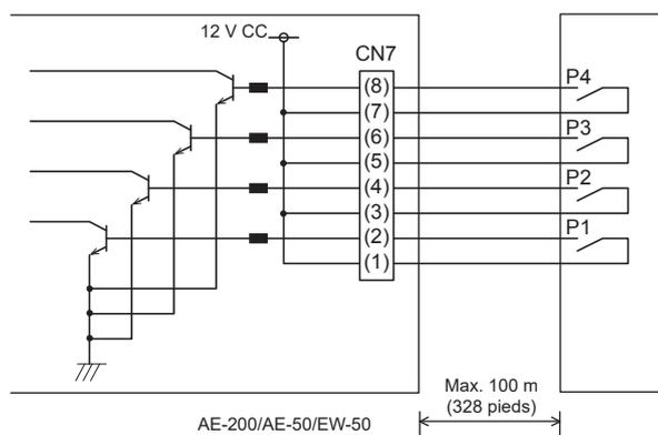
Une tension de 12 V CC est appliquée à CN7. N'appliquez pas une tension d'alimentation provenant d'une autre source d'alimentation.
