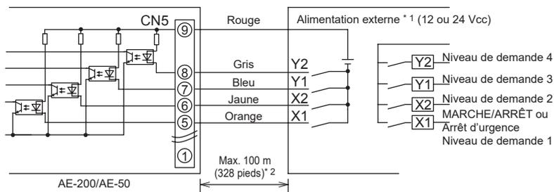
Utilisez des relais X1, X2, Y1 et Y2 conformes aux spécifications suivantes.
