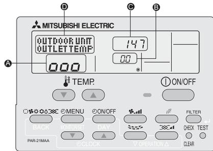
Le mode d'entretien permet d'afficher de nombreux types de données d'entretien sur la télécommande à fil, comme la température de l'échangeur de chaleur et la consommation actuelle du compresseur pour les appareils intérieur et extérieur. Cette fonction peut être utilisée que le climatiseur fonctionne ou non.
