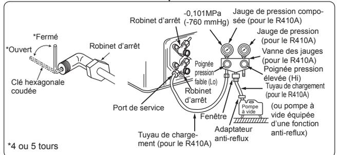
Enlever rapidement la soupape multiple de manomètre de la sortie de service de la soupape d'arrêt.
