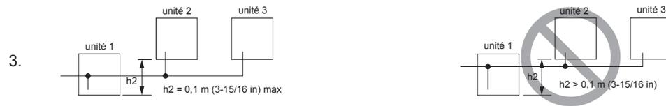
L'exemple NG illustre une accumulation d'huile dans l'unité 1, que l'unité 3 est en cours d'utilisation et que l'unité 1 est arrêtée. La différence entre l'unité et l'unité en hauteur (h2) doit être de 0,1 m (3-15/16 in) maximum.
