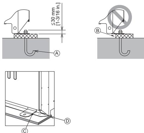
(A) Boulon d'ancrage M10 fourni sur le terrain (B) Le coin n'est pas logé.
