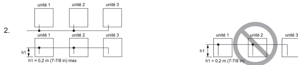
L'exemple NG illustre une accumulation d'huile dans les unités 1 et 2, que l'unité 3 est en cours d'utilisation et que les unités 1 et 2 sont arrêtées. La hauteur (h1) du tube vertical doit être de 0,2 m (7-7/8 in) maximum.
