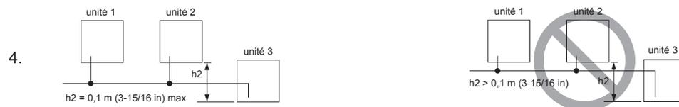
L'exemple NG illustre une accumulation d'huile dans l'unité 3, que l'unité 1 est en cours d'utilisation et que l'unité 3 est arrêtée. La différence entre l'unité et l'unité en hauteur (h2) doit être de 0,1 m (3-15/16 in) maximum.
