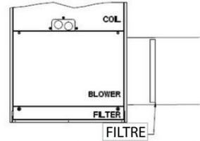
Joint de conduite de retour latérale double, partie inférieure de l'appareil de traitement d'air, ajouter deux filtres
