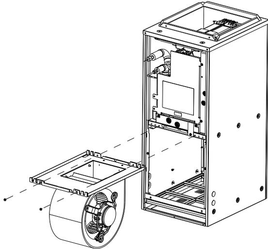
**Étape. 5** Déposez les (2) vis indiquées dans l'image et glissez l'ensemble de la soufflante complet hors de l'enceinte.
