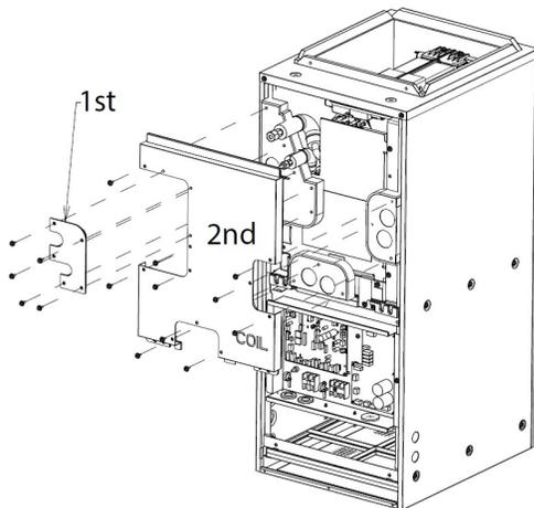
**Étape. 3a** Déposez les vis retenant les (3) panneaux sur le panneau COIL (serpentin) montrés dans l'image ci-dessus. Déposez le 1er et le 2e panneau marqué « COIL » (serpentin).
