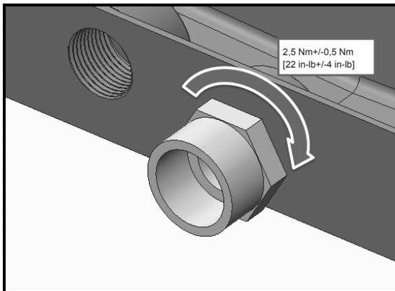
L'appareil de traitement de l'air comporte des raccords de vidant FPT de  $\frac{3}{4}$  po. Lorsque l'appareil est installé à la verticale, il y a un jeu. Lorsque l'appareil est installé à l'horizontale, il y a un jeu. Chaque jeu comprend un drain principal et un drain secondaire ou auxiliaire. Le drain principal est celui le plus bas (de niveau avec le fond du bac). Le drain secondaire est à un niveau plus élevé. Ils sont étiquetés dans les dessins dimensionnels ci-dessus.
