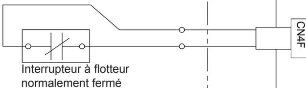
Lorsque l'interrupteur à flotteur normalement fermé s'ouvre, l'appareil intérieur s'arrête.
