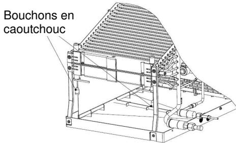
**Étape. 10c** Déposez les bouchons indiqués dans l'image ci-dessus.
