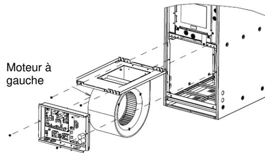
**Étape. 7** Réinstallez l'ensemble de la soufflante avec le moteur maintenant du côté gauche dans l'enceinte de l'appareil de traitement de l'air et réutilisez les (2) vis qui fixaient l'ensemble en place. Réacheminez le connecteur du moteur dans l'enceinte et rebranchez-le. Réinstallez le boîtier de commande.
