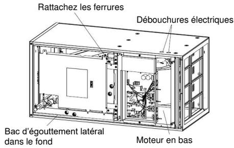
**Étape. 11** Réinstallez l'ensemble du serpentin avec les ferrures qui le fixent. Ne pas réinstaller les ferrures entraînera une perte de capacité et la formation de condensation dans l'enceinte. Assurez-vous que le faisceau de la thermistance est connecté dans le logement du serpentin dans l'enceinte. Reportez-vous aux étapes 1 à 4 de la section 9.3 pour remonter les panneaux. Assurez-vous que les bonnes débouchures sont enlevées pour le drainage et les raccordements électriques.
