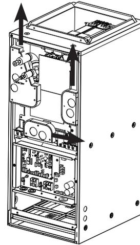
**Étape. 3b** Ensuite, déposez les petits panneaux couvrant les orifices de drainage et les conduites de frigorigène en les glissant dans le sens indiqué ci-dessus.
