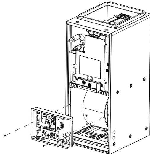
**Étape. 4** Déposez toutes les connexions électriques entrant dans le boîtier de commande. Cela comprend le connecteur du moteur. Sortez ces faisceaux de câblage du boîtier de commande. Ensuite, déposez les (2) vis indiquées dans l'image et déposez le boîtier de commande de l'appareil de traitement de l'air.
