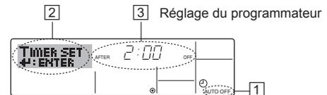
1. Assurez-vous que vous êtes sur un écran de contrôle standard, et que le témoin du programmateur Arrêt Auto s'affiche (en ①). Lorsque qu'une fonction autre que le temporisateur à extinction automatique est affichée, réglez la télécommande sur AUTO OFF TIMER en utilisant le paramètre de fonction temporisateur de la sélection des fonctions (voir 8.[4]-3 (3)).
