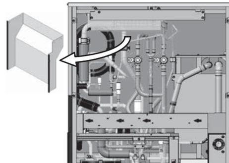
2) To remove the 4-Way Valve Assy
